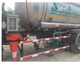
รูปที่ 76 รถขนส่งสารเคมี และอุปกรณ์ระงับเหตุฉุกเฉินประจำรถ
