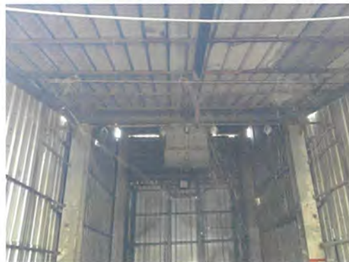
รูปที่ 42 สายพานลำเลียงถ้ำแบบปิดครอบ และหัวสเปรย์น้ำ บริเวณพื้นที่การขนถ่ายลงรถบรรทุก
