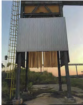
รูปที่ 43 สายพานลำเลียงกากตะกอนหมักกรองแบบปิดครอบ และหั่วสเปรย์น้ำ บริเวณพื้นที่การขนถ่ายลงรถบรรทุก
